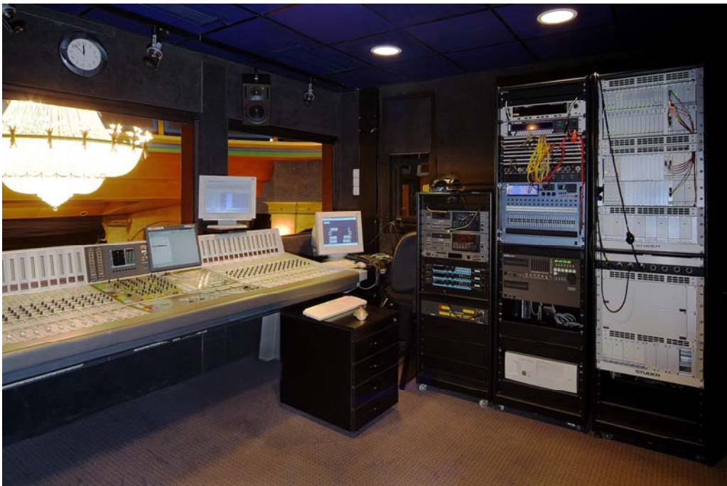
A Nemzeti Színház hangvezérlője. Balra a digitális keverő kezelőfelülete, jobboldalon a helyi interfészeket tartalmazó rack, mellette a bejátszókat, kommutáló egységet, egyéb jelformáló berendezéseket tartalmazó keretek.
